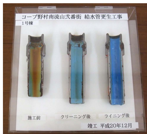
図 4 給水管(専有部)の更生(2008 年)
