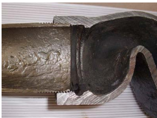
図 7 ユニットバス系統の排水管（南流山貳番街）
