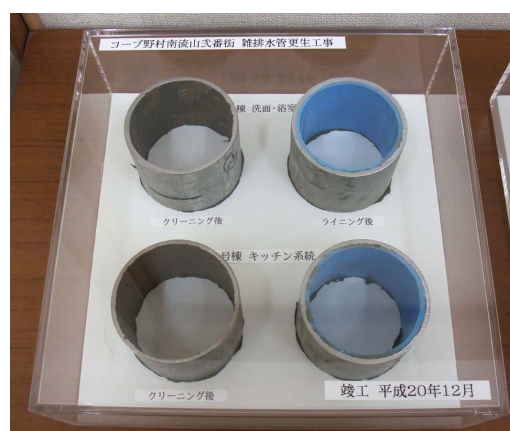
図 5 排水管の更生(2008 年)
