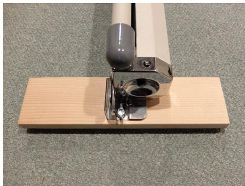
板材はスクリーンの本体部の回転防止用で本体の単部の固定穴を利用して蝶ボルトで固定（幕面のキャップは経年劣化から補修）。
