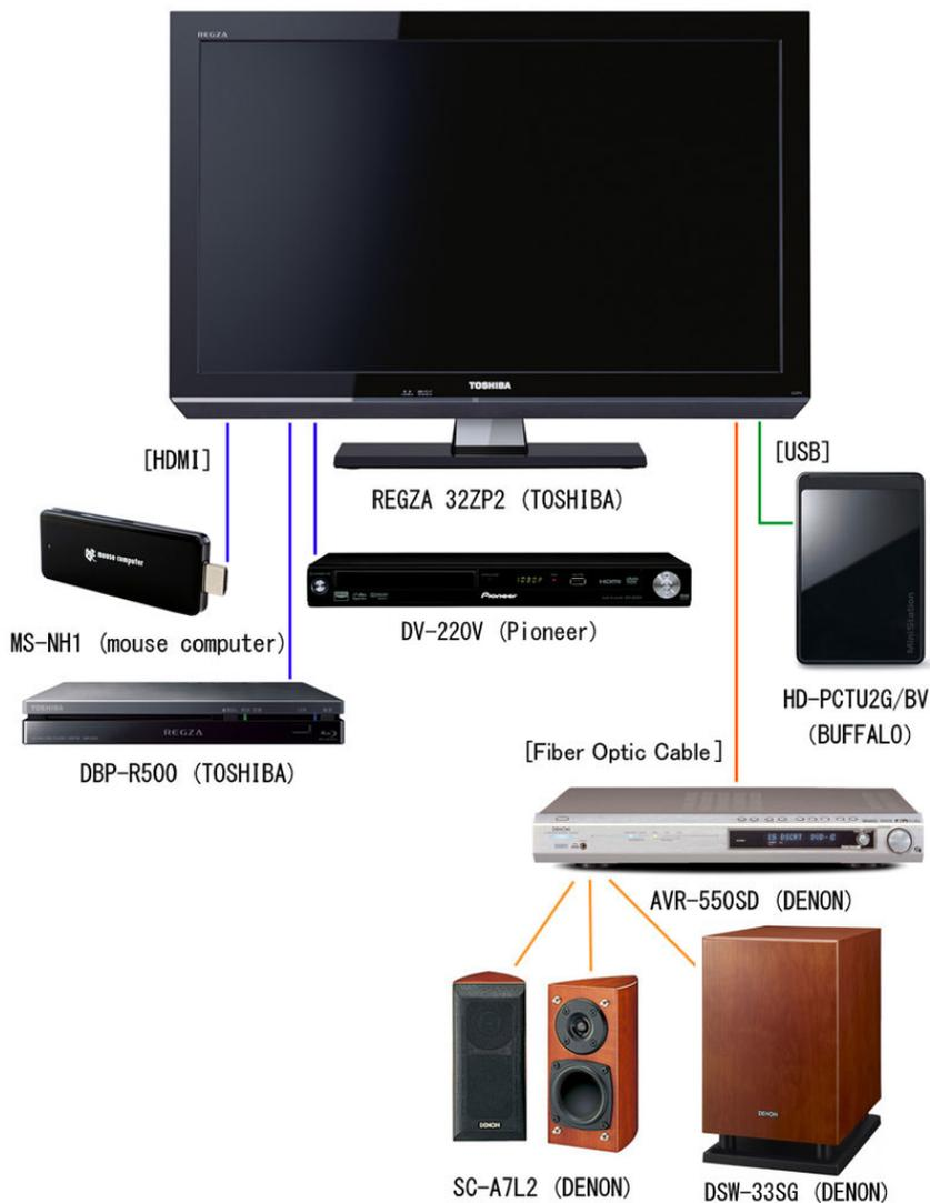
LDで使用のREGZA 32ZP2には上図のように周辺機器が接続されています。著者のLDのシステムはTVが映像機器等の選択に使用され、AVシステムの中核になっていることに気付かされます。次に接続している機材について紹介します。
