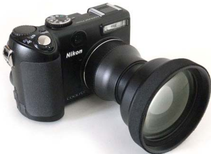
テレコンバーターTC-E2 (Nikon) レンズ構成：3 群 4 枚、コンバーター倍率：2 倍 大きさ：φ65×45mm、質量：約 150g
