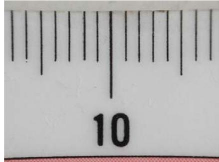
FUJIFILM XQ1 改にステップダウンリング 43-37 でスーパーマクロレンズ MSN-202 (Raynox) を組合せてみました。XQ1 の望遠端で作例のように約 30mm の距離から約 15mm (35mm 判換算約 2.4 倍) が撮影できましたが、画像周囲が甘く、糸巻き型の歪曲収差も確認され、XQ1 への MSN-202 の組合せは適しているとはいえません。
