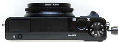
ズームレンズ先端に加工したステップアップリングを貼り付け
