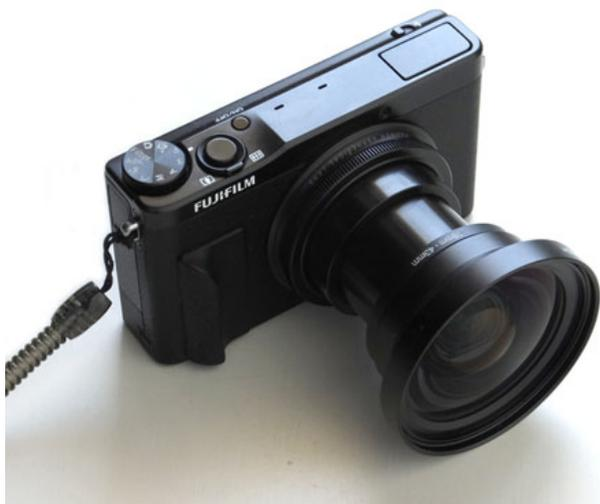
FUJIFILM XQ1（改）とワイドコンバージョンレンズ DW-6（RICOH）の組合せ
