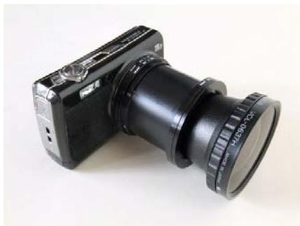
デジタルハンディカム DCR-PC10 (SONY、ズームレンズ：35mm 判換算 42～504mm) 用に入手した 0.6 倍のワイドコンバージョンレンズ VCL-0637H (SONY) のネジ径は 37mm です。そこで MSN-
