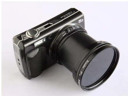
製作したアダプターは構造上、ケラシなく使えるのが焦点距離 10mm (35mm 判換算 44mm) 以上です。著者は手持ちの 58mm の各種フィルターを活用するため、ステップアップリング 55→58mm を入手しました。
