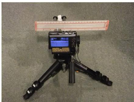
F200EXR の近接撮影能力、マクロ時（広角）でレンズ先端より、5cm と仕様にあります。微動雲台につけた定規を対象に測定したところ、広角端でレンズ先端より **32mm** の位置で撮影できました。個体差もありますが、仕様より近接撮影能力が高いようです。
