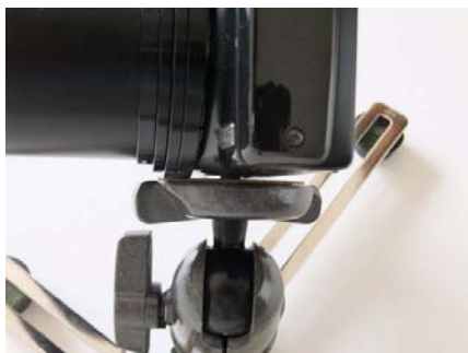
カメラと雲台の間に隙間
