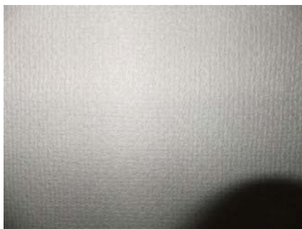
右下はレンズ先端によるフラッシュ光のケラレ（広角端）
