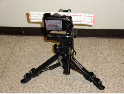
mini-F & Macro Slider に FinePix F300EXR と定規を載せた実験状況
