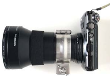
三脚座を取り付けた状態
