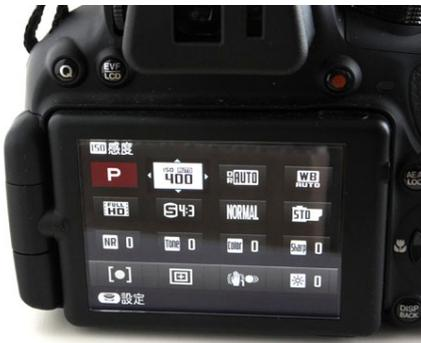
HS30EXR までのダイレクトファンクションボタン、HS50EXR ではバリアングルタイプ液晶モニターが採用されたことから位置関係から両立しないことから廃止され、新たに Q ボタンが設けられ、セレクトボタン、コマンドダイヤル
