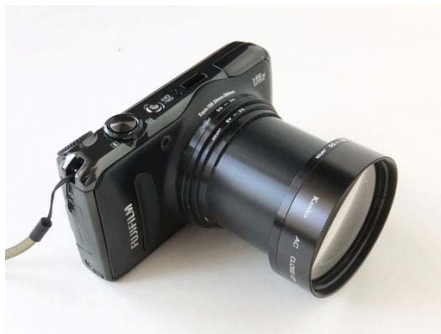
AC クローズアップレンズ No.5 撮影倍率：35mm 判換算 0.28～1.8 倍 合焦距離：170～200mm
