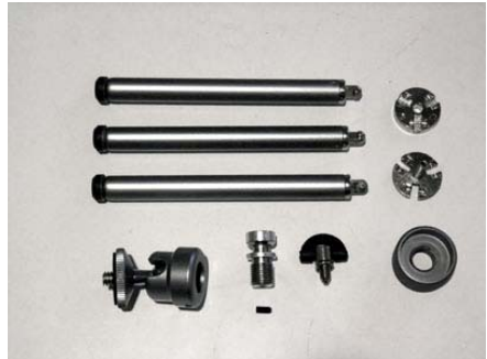
E-1650 を分解した状態（左上：伸縮脚、右上：伸縮脚の軸部を挟む（！）底部、左下：雲台、中下・右下：ローアングルを実現するための部品）
