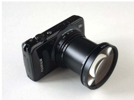
B-MACRO (No.2.5 相当) 撮影倍率：35mm 判換算 0.17～1.2 倍 合焦距離：270～360mm
