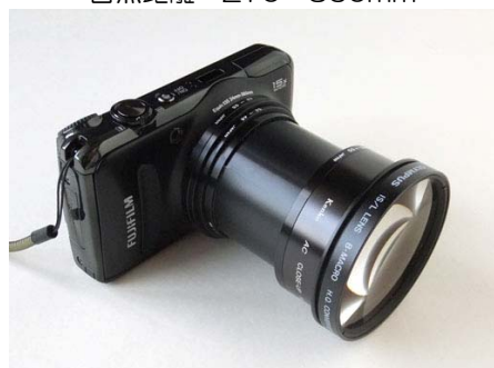
AC クローズアップレンズ No.5 と B-MACRO の組合せ (No.7.5 相当) 撮影倍率：35mm 判換算 0.44～2.7 倍 合焦距離：112～122mm
