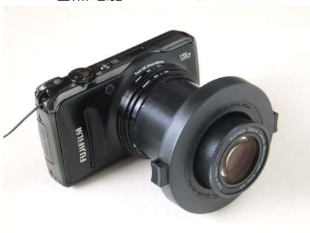
MSN-202 スーパーマクロレンズ (Diopter 25 相当) 撮影倍率：35mm 判換算 3.1～8.1 倍 合焦距離：35mm
