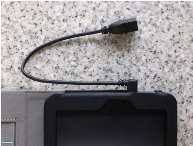
USB ホストケーブル A-Micro-B (左L型) (ainex) の取付け状況
