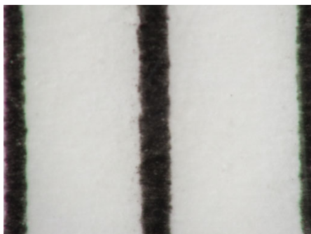
MSN-202 スーパーマクロレンズ (raynox) の組合せでの望遠端 距離 32mm で 35mm 判換算約 16 倍
