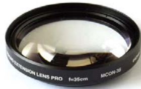
MCON-35 (OLYMPUS)、f=35cm レンズ構成：2 群 2 枚、 取付ねじ径：62mm
