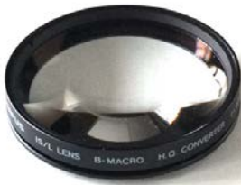
B-MACRO (OLYMPUS)、f=40cm レンズ構成：2 群 2 枚、 取付ねじ径：55mm
