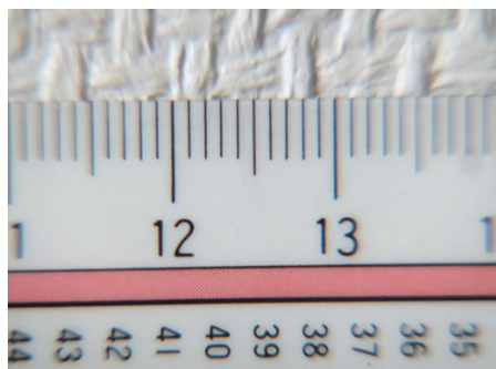
FinePix F300EXR、TCON-17、MC CLOSE-UP +2 と組み合わせて撮影した定規（撮影距離：レンズ先端より 46cm）
