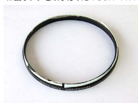
ネジ部に両面接着テープを貼付け状態
