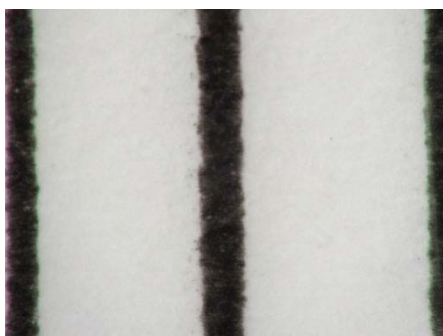
MSN-202 スーパーマクロレンズ (raynox) の組合せでの望遠端 距離 32mm で 35mm 判換算約 16 倍 スケールの約 2mm の範囲を撮影
