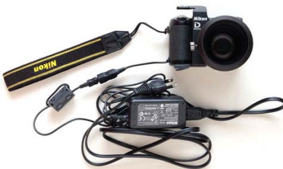
COOLPIX P5100 と EH-62A、FSB-6 を組み合わせた状態
