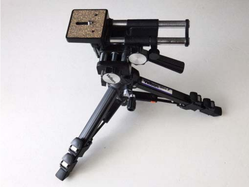
Macro Slider（微動装置）前後スライド:65mm、左右スライド 26mm、0.68kg Mini F 伸長 55cm、縮長 30cm、EV スライド量 6.5cm、重量 1.1kg
