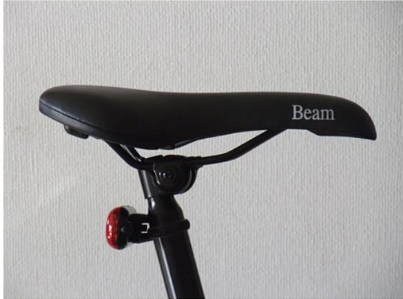
図 15 ヤグラの取付方向（前後入替）
