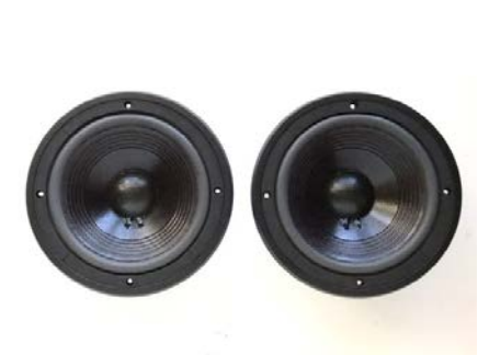
12) エッジの修復を完了し、化粧リングを貼り付けたウーファー
