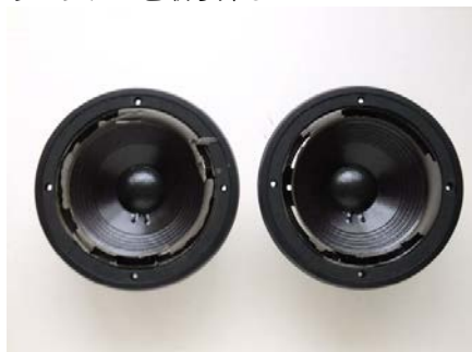
4) 外したウーファー（取り外し作業中 にエッジは更にボロボロに）
