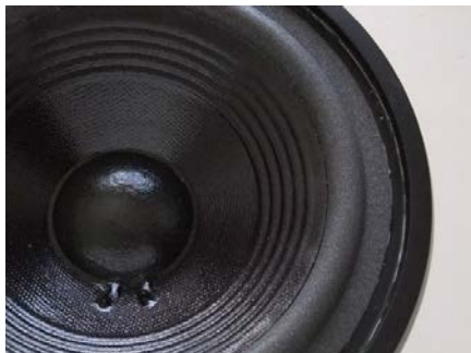
9) エッジを取り付けた状態 *2
