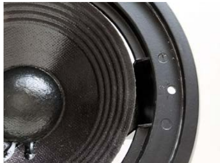
8) アルミダイキャストフレームについてエッジの残りなどを除去後の状態 *1
