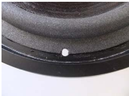
11) ネジ穴を塞ぐエッジの部分をカッターで除去
