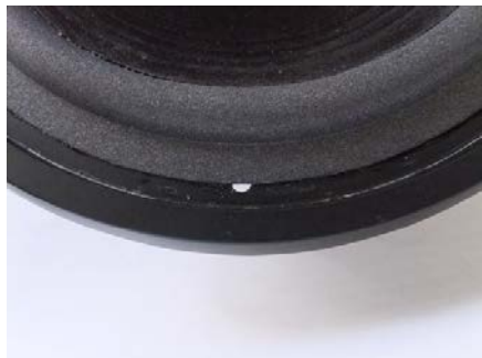
10) ダイキャストフレームのネジ穴の部分にエッジが塞いだ状態
