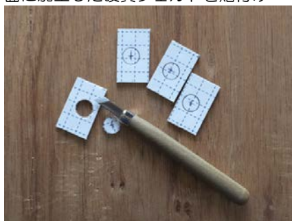
硬質フェルトを彫刻刀で孔明け
