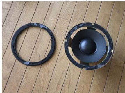
5) ウーファーから化粧リング（合成樹脂製）を外した状態
