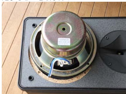
3) ウーファー（重さ 1,460g）をスピーカーボックスから外して裏返し
