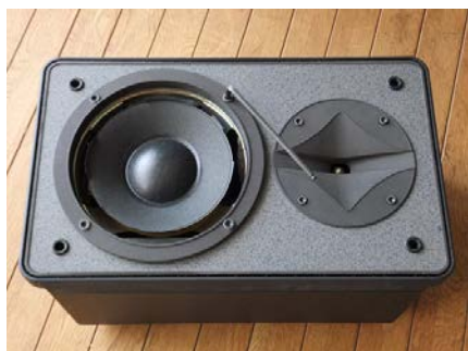
1) ヘキサゴンレンチでウーファーを固定するビスを取り外し
