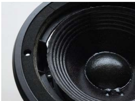
5) エッジの除去作業中（アルミダイキ ャストフレームに化粧リング）
