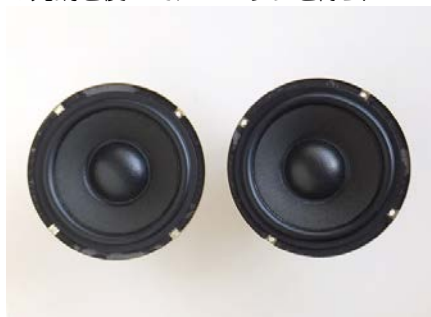
9) ファンテックの取り扱い説明書に従ってエッジを交換したウーファー
