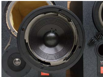
2) プラスドライバー No.2 を用いて ウーファーを取り外し
