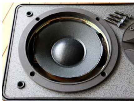
2) 六角孔付き木ネジ?!を取り外した状況
