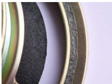
7) 爪で、爪の届かないところはカッターの先端を使って古いエッジを除去
