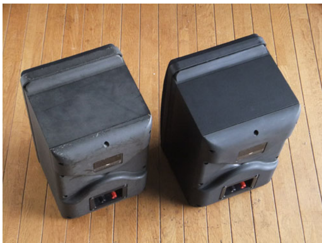
左：黒色スエード調仕上が経年劣化でベトついた状態、 右：マジックリンで劣化した層を除去した状態
