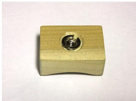
4) 木片に約 8mm の穴を開け、そこに止めネジアダプターをねじ込む。止めネジアダプターをねじ込む際、ブラケット用止めネジを付けた状態でねじ込むと、取り付け面に対して比較的正確に鉛直方向に取り付けられる。ねじ込み後、雲台のカメラ台に取り付け、隙間の状態を確認し、隙間があれば木片の下面を板の上に置いた紙やすりで削って微小精子、隙間がないようにする。
