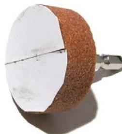
軸付砥石の端面にビニルテープを貼り、加工時に誤ってステップアップリングの余分な部分を削らないように
