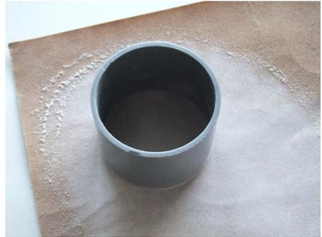
平板に紙やすりを載せてその上で VU 管の削る位置に多く力を加え端面を削る
