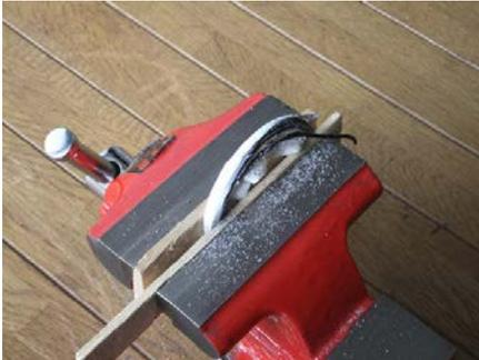
ステップアップリングを木片で養生してバイスで挟み、ハックソーでネジ部カット
