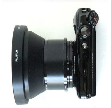
上に製作した前出のスケッチに基づいて製作した FinePix F200EXR、F300EXR に対する TCON-17 用アダプター、WL-FXS6 用アダプターを示します。
