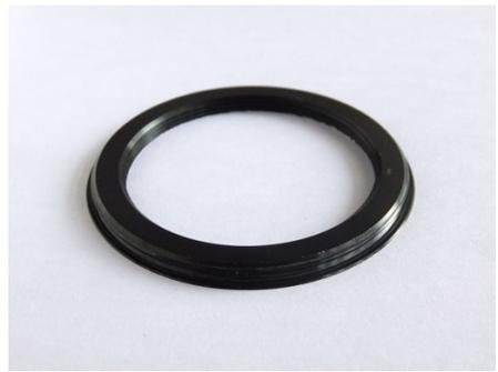
金工ヤスリで削った面を#600の紙やすりで研磨仕上げします。
