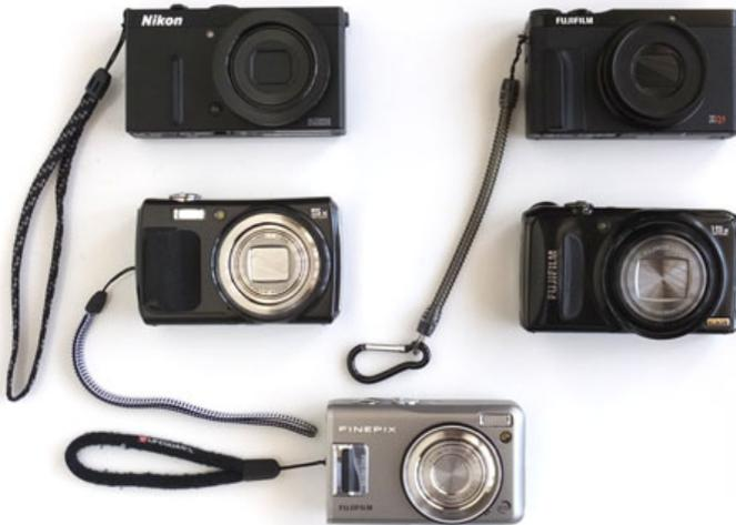
フィルターネジに対応していないカメラをフィルターネジに対応させるにはレンズ先端にフィルターネジを付加する方法と、ボディ側にフィルターネジに対応した接続アダプターを装着可能な構造とする方法があります。前者は接続アダプターが不要でズームレンズの伸縮の影響を受けませんが、フィルターネジのないズームレンズは先端荷重を想定していない設計で組合せるレンズ等が制約されます。そこで後者のボディ側にフィルターネジに対応した接続アダプターを装着する構造が荷重面から実際的といえます。
