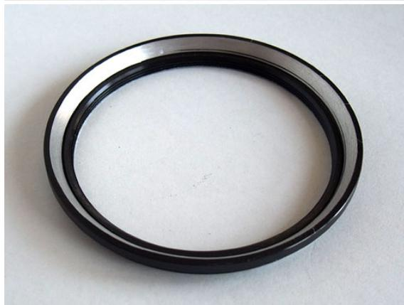
67 → 62mm のステップダウンリングの内側を削って WL-FXS6 と干渉しないようにし、WL-FXS6 が 62 → 58mm のステップダウンリングの端面で当て止めできるようにしました。
