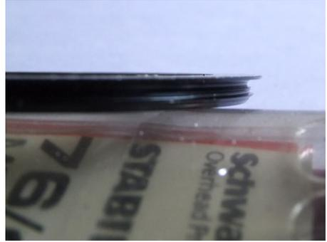
金工ヤスリで 2.5mm 厚のフランジを 0.25mm 厚まで削ります。他の工具を併用することも考えられましたが、ネジ部を痛めるおそれがあるため、ひたすら忍耐を使って金工ヤスリで削ります。
